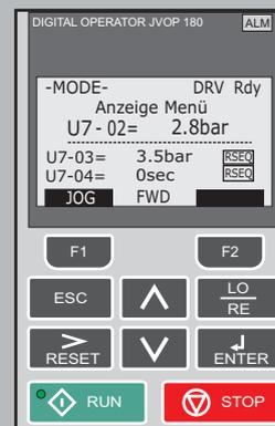
Nach dem Einschalten wird bei richtiger Einstellung und Anschluss der Anlagendruck angezeigt.
