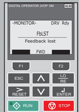
Wird der Drucktransmitter falsch oder nicht angeschlossen erscheint diese Meldung nach dem Einschalten auf dem Display.
