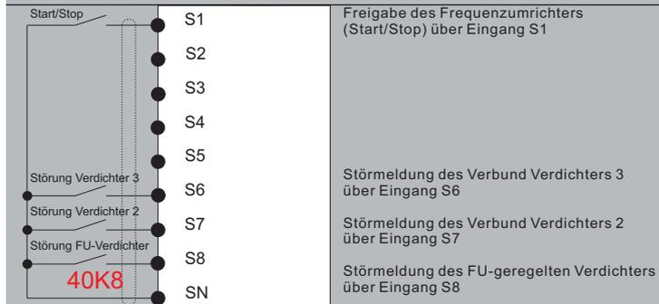
**Verdichterregelung mit einem FU-geregelten Verdichter und 2 Verdichtern die direkt über das Netz zugeschaltet werden.** Jeder Verdichter verfügt über einen eigenen Motorvollschutz und einen Hochdruckschalter. Störungen werden über ein Koppelrelais auf die jeweiligen Eingänge gegeben.
