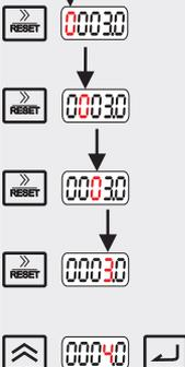
Durch Drücken der **Reset** - Taste wird die entsprechende Dezimalstelle angewählt.
