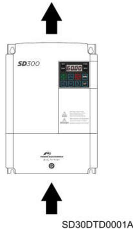
Abbildung 6.4 Kühl-Luftströmung im Frequenzumrichter
