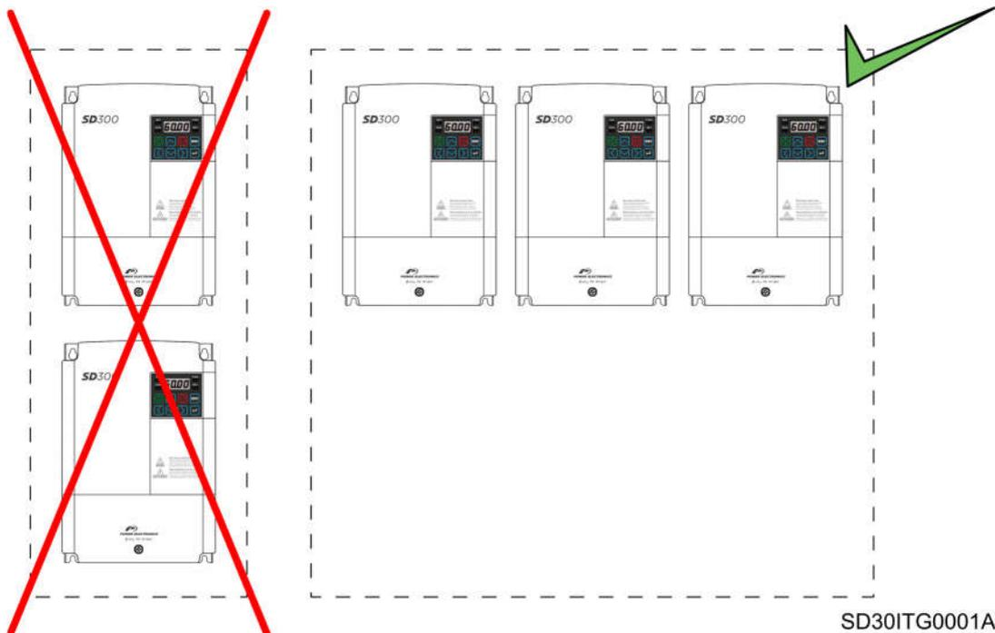
Abbildung 6.3 Montage von mehreren Geräten
