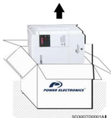
Abbildung 5.1: Auspacken des Frequenzumrichters
